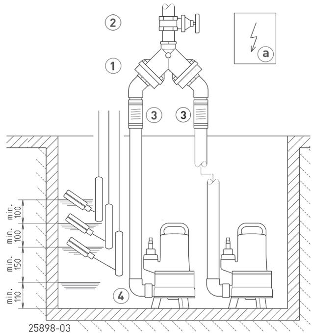
Zudem ist der Einbau einer EN 12050-4 geprüften Rückschlagklappe vorgeschrieben. Wir empfehlen zusätzlich eine Alarmanlage für die Überwachung.
