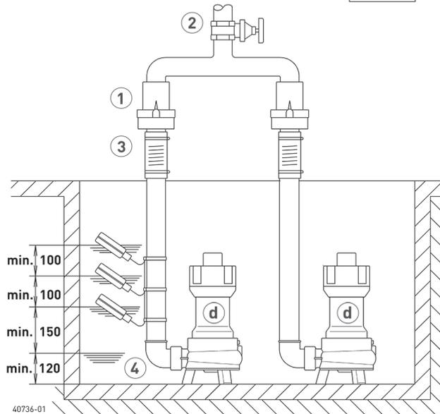
Zudem ist der Einbau einer EN 12050-4 geprüften Rückschlagklappe vorgeschrieben. Wir empfehlen zusätzlich eine Alarmanlage für die Überwachung.
